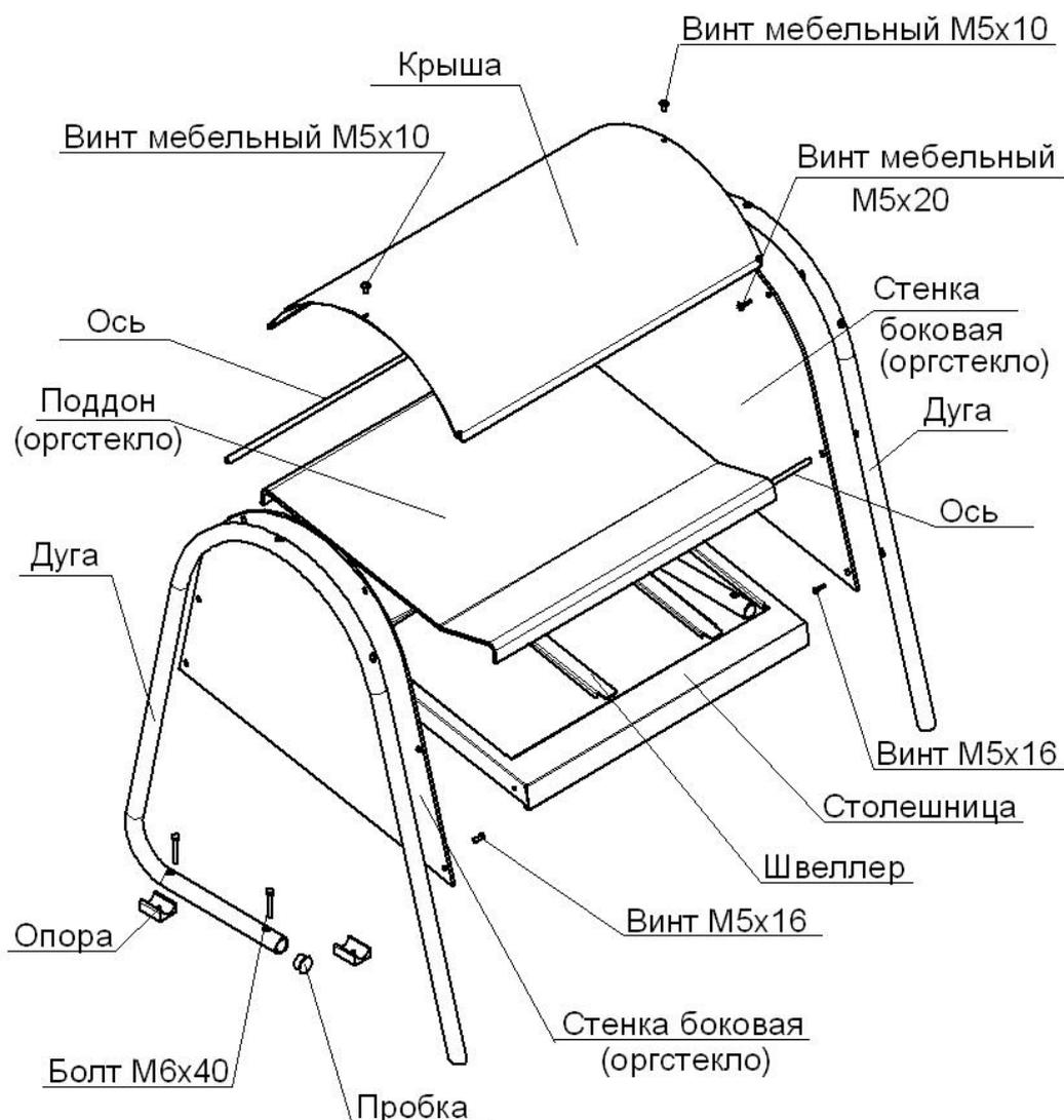
Рис. 2 Схема сборки ПСПХ-70М и ПСПХ-70М (кашир.)
